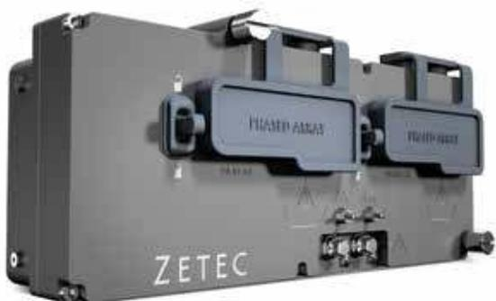
**探头分线器:** 同时连接两个 PA 探头, 实现焊缝双侧双探头检测。探针分配器有三种类型: IPEX, ZPAC 和 Omni 型探头连接器。
