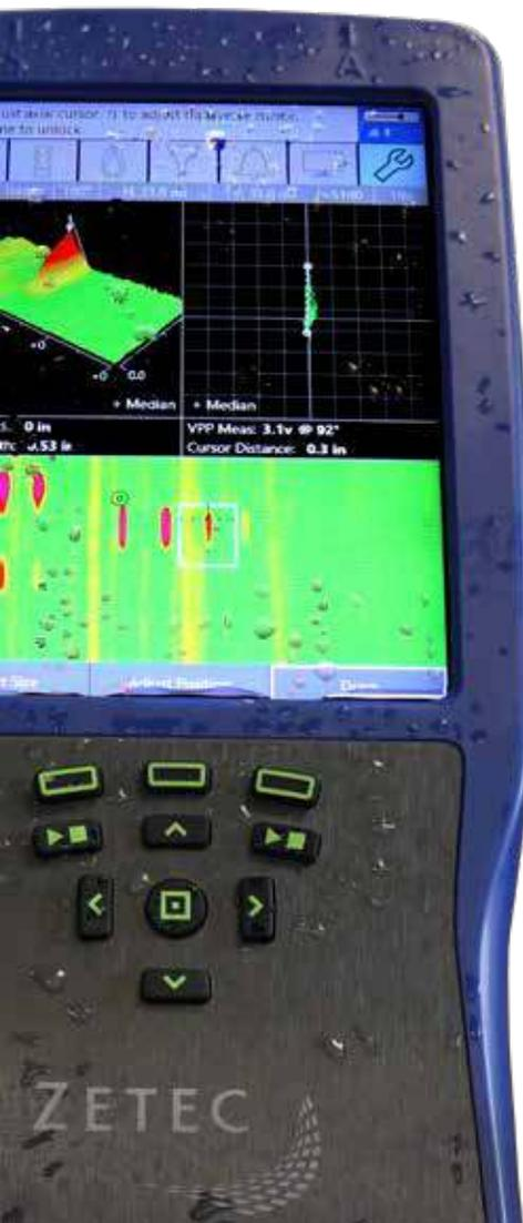
**다층 부식 검사.** 부식의 식별은 항공기체 검사의 가장 중요하고 복잡한 측면 중 하나입니다. 일반적으로 표면 두께의 변화와 다양한 다층 구조는 신호를 인식하기 어렵게 만듭니다. MIZ-21C는 두꺼운 부분을 관통 하는 힘이 있습니다. 탁월한 신호 대 노이즈 비율은 검사자가 소량의 물질 손실도 구별할 수 있도록 도움을 줍니다. 조합된 (Mixing) 이중 주파수는 관심 신호를 차폐 할 수 있는 층 사이의 다양한 공극에(Air gap) 의해 발생하는 원치 않는 신호를 대부분 제거합니다.
