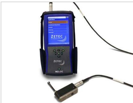
ZM-5 con sondas de escáner de reflexión y MIZ-21C ofrece un sistema completo "listo para la inspección".
